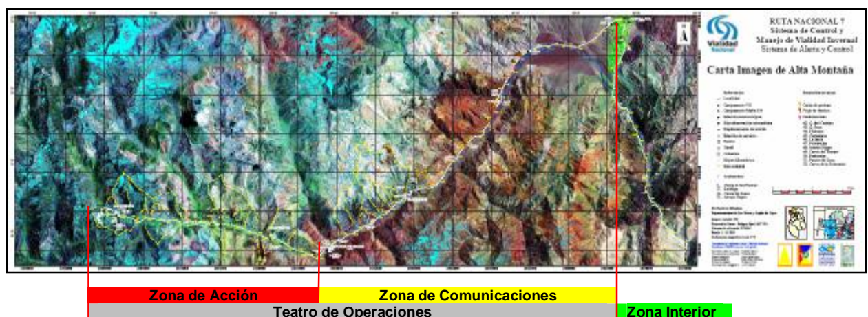
Figura 3. El mural del COT, de 4.4 m de largo. En él se visualiza todo el Teatro de Operaciones del tramo de alta montaña de la RN7, y se fijan magnéticamente íconos ambientales, sitios críticos y posiciones de estaciones meteorológicas, nivométricas, campamentos, cuadrillas y equipos. Está instalado en el Campamento Uspallata (UCO).
