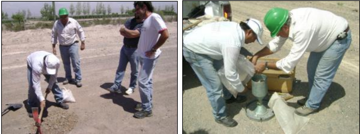
Figura 13. Recolección de muestras del material de superficie de rodadura en los tramos
