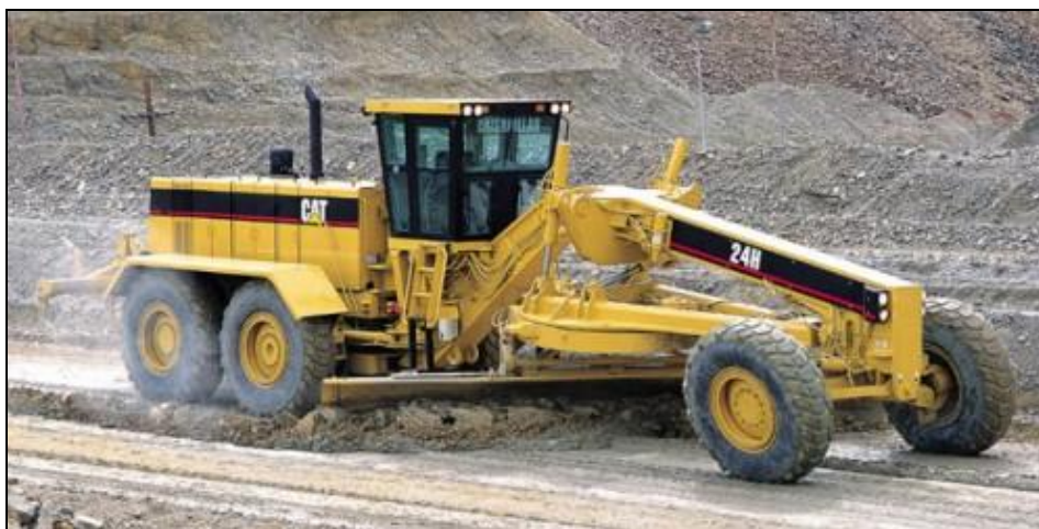
Figura 1. Motoniveladora realizando tareas de reperfilado en un camino no pavimentado
