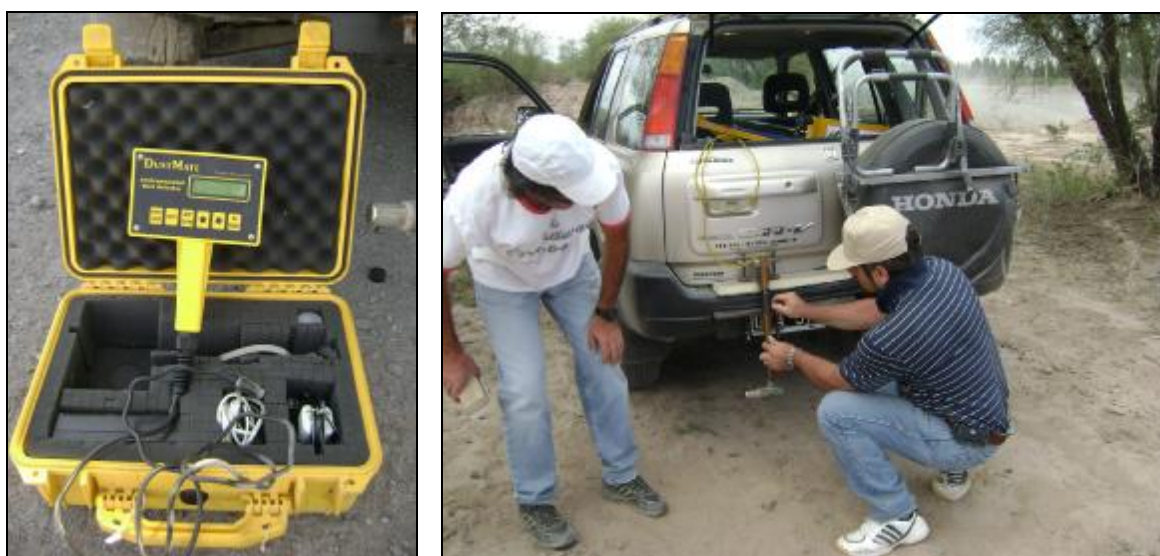
Figura 22. Aparato medidor de polvo y su instalación en el vehículo de medición
