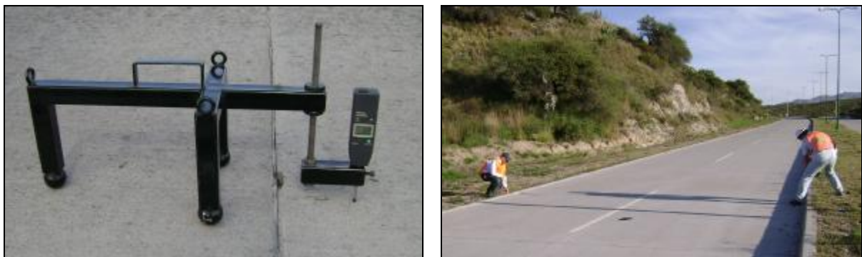
Figura 6. Escalonímetro utilizado y relevamiento de deterioros en campaña
